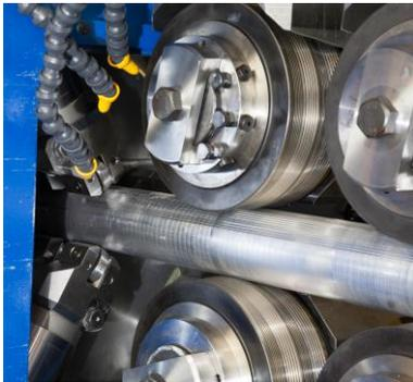
Die neue Anlage ist hier Teil einer hochmodernen Produktion für Halbzeuge, Sondermaterial für die Automobilindustrie und Pressbolzen. Die Schälmaschine ist ausgelegt für einen Arbeitsbereich von 50 – 203 mm, Materiallängen von 3 - 7 m und Vorschubgeschwindigkeiten von bis zu 0,5 m/sek.
