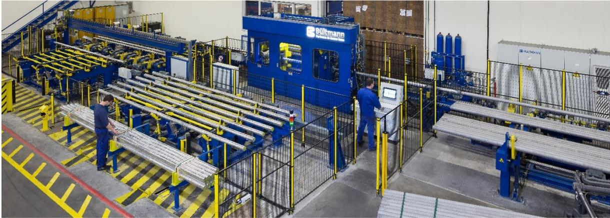
Die kürzlich neu entwickelten BÜLTmann-Hochleistungsschälmaschinen für Al-Stangen, die das Strangpressen von Stangen erfolgreich ersetzen, haben sich inzwischen bei diversen Kunden bestens etabliert, zum Beispiel bei einem der führenden europäischen Lieferanten für Aluminiumprodukte und -halbzeuge. Mit Hilfe der BÜLTmann Schälmaschine werden aus runden Pressbolzen homogene Präzisionsstangen mit hoher Oberflächenqualität.
