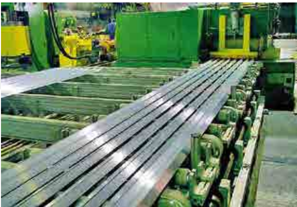
Strangpressenauslauf für Aluminiumprofile und -rohre mit Lagensäge Runout system behind extrusion press for aluminium profiles and tubes, with layer saw
