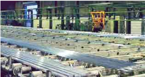
Strangpressenauslauf für Aluminiumprofile Runout system behind extrusion press for aluminium profiles
