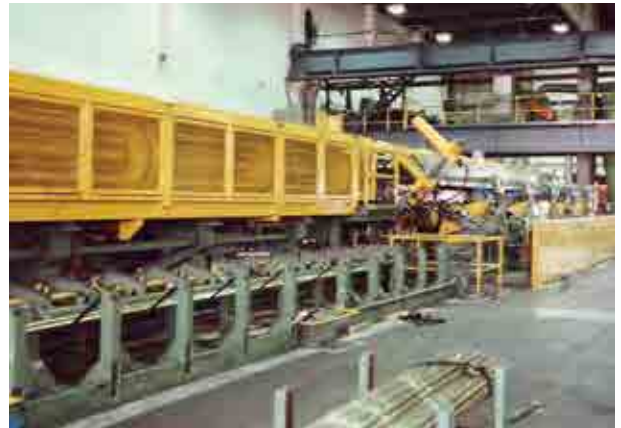
3-fach-Ziehanlage für Profile, Stangen und Rohre aus Messing, mit Beseifungsbecken, Vereinzelungssystem und Sägeanlage
