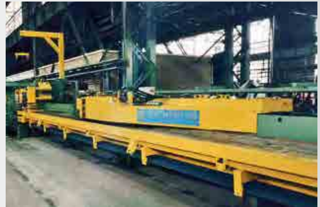
Kombinierte Zieh- und Reckanlage für Kupferprofile und -stangen Combined drawing and stretching line for copper profiles and bars
