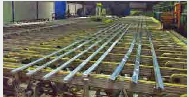
Strangpressenauslauf für Aluminiumprofile mit Lagensäge Runout system behind extrusion press for aluminium profiles with layer saw
