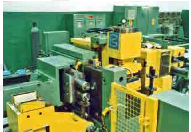
2-fach-Profil- und Stangenziehmaschine für Messingprofile und -stangen u.a. mit Anfräsmaschine, Push-Pointer, Richtanlage, Lagensäge
