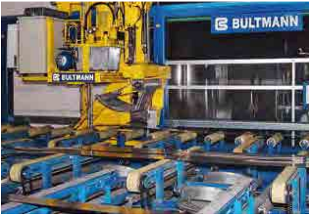
Puller im Strangpressenauslauf für Aluminiumprofile und -rohre Puller within runout system behind extrusion press, for aluminium profiles and tubes
