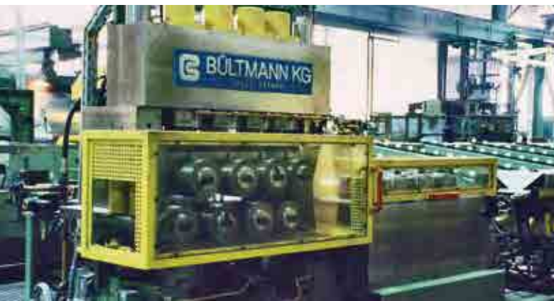
2 x 8-Rollen-Profilrichtmaschinen für kupferlegierte Profile und Stangen 2 x 8-roll straightening machines for copper-alloyed profiles and bars
