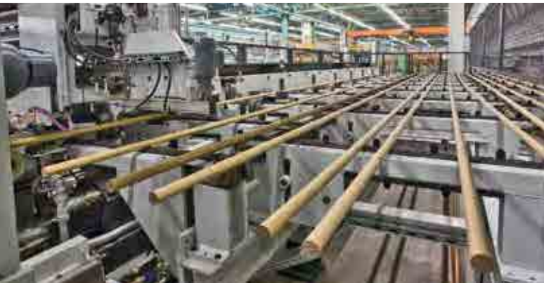
Einlauf zur Ziehmaschine Entry system to the drawing machine
