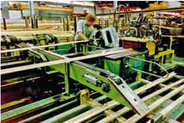
Reckanlage für Messingprofile mit Entdrallkopf und Säge Stretching machine for brass profiles with detwisting head and sawing unit
