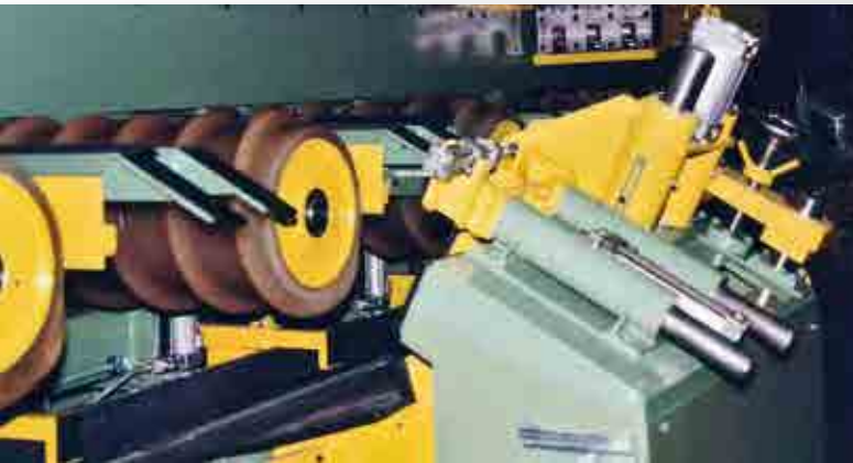
Mehrfach-Sägenanlage für Profile, Stangen und Rohre aus Messing, in Linie mit einer Ziehmaschine Multiple sawing unit for brass profiles, bars and tubes, working in line with a drawing machine
