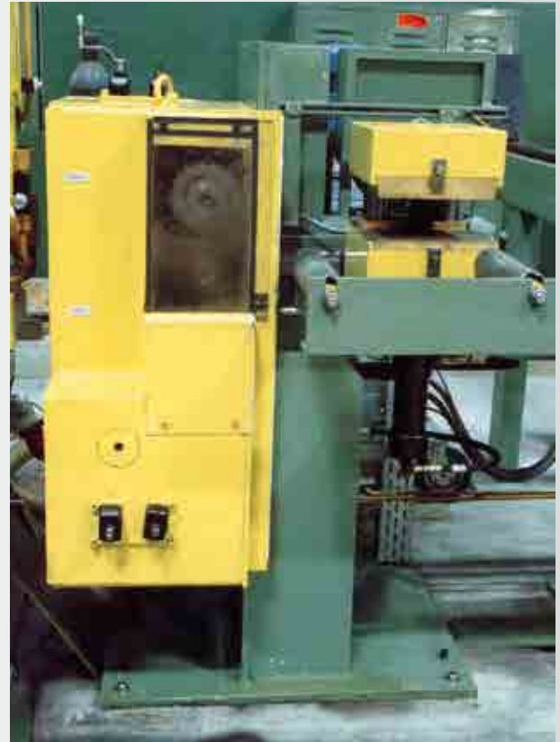
Anfräsmaschine für Messingprofile innerhalb einer Profiliziehmaschine Milling machine for brass profiles arranged within a profile drawing machine
