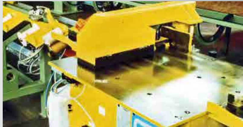
Lagensäge für kleine Messingprofile und -stangen Layer saw for small brass profiles and bars
