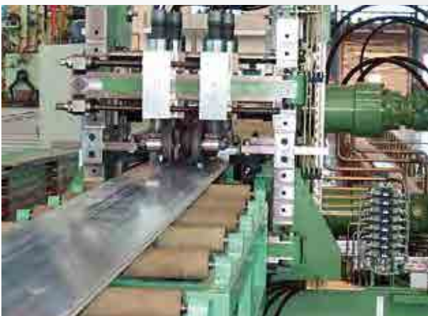
Richt- und Profilkorrigiermaschine für große Aluminiumprofile
