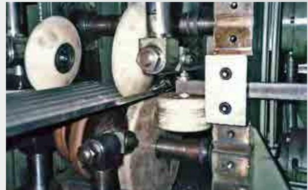
Korrekturrollen einer Richt- und Profilkorrigiermaschine für große Aluminiumprofile
