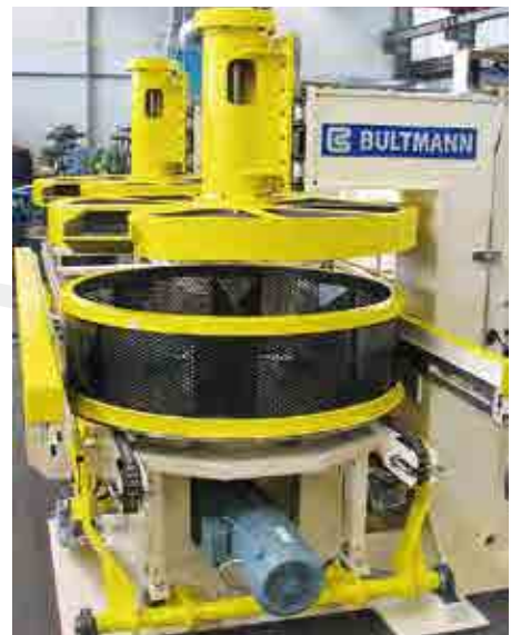
Aufcoiler im Strangpressenauslauf für kupferlegierte Profile und Rohre Coiler for copper-alloyed profiles and tubes, arranged in the runout of an extrusion press
