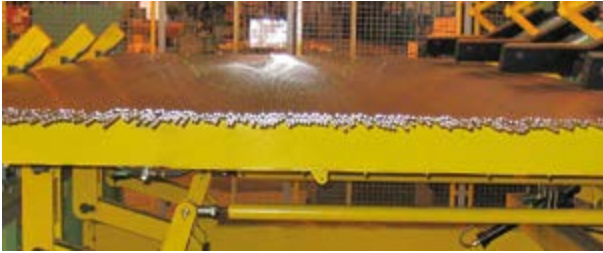
Vereinzelung und Lagenbildung vor einem Glühofen Separation system and layer forming in front of an annealing furnace
