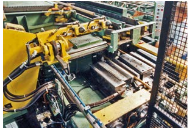
2-fach-Einschubvorrichtung in einer 2-fach-Stangen- und Profildrehmaschine für Messingstangen Double push-in device within a double drawing machine for brass bars and profiles
