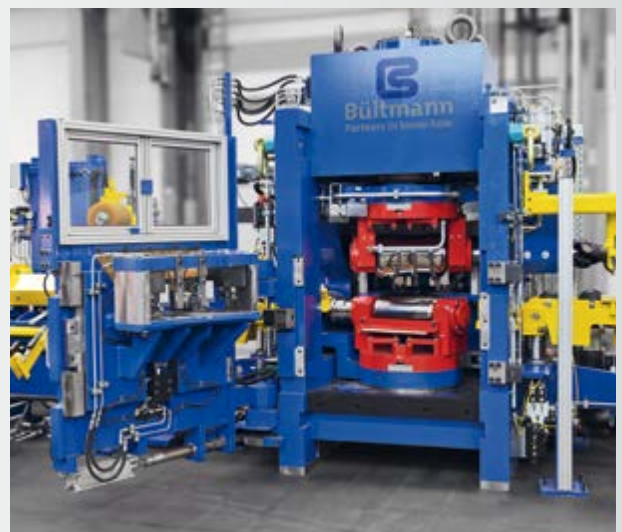
2-Walzen-Richt- und Poliermaschine für geschälte Stangen 2-roll straightening/polishing machine for peeled bars
