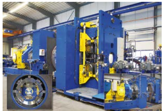
Schälmaschine für Edelstahlstangen bis zu 420 mm Stangendurchmesser
