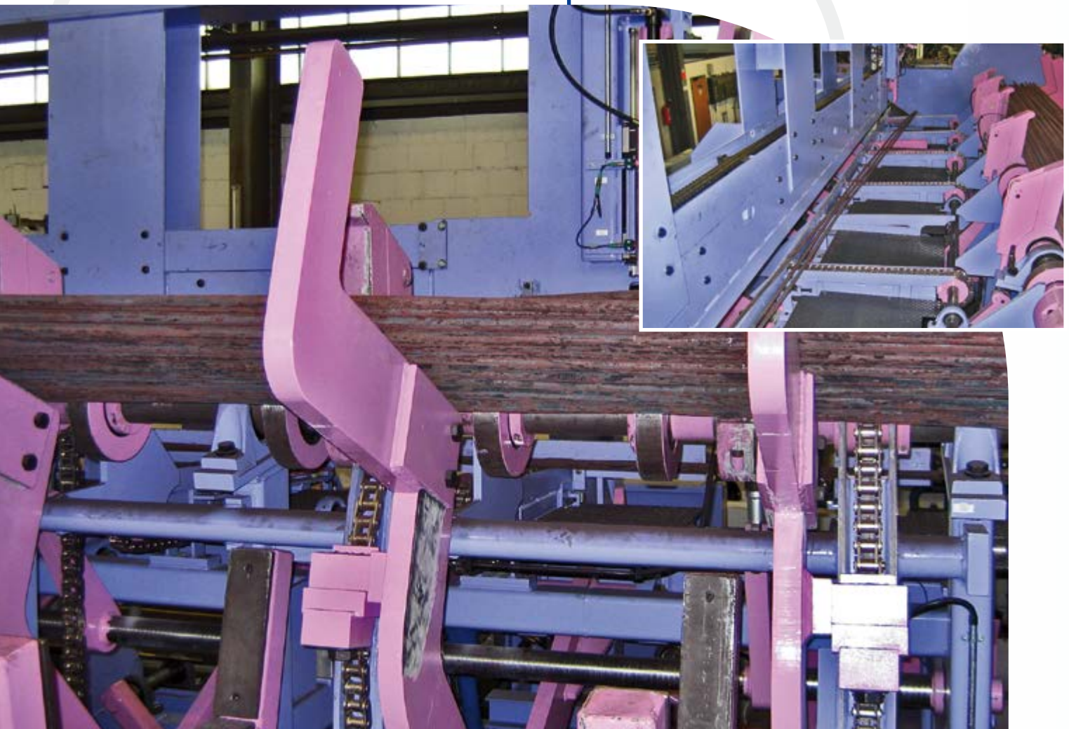
Stangenvereinzlung vor einer Richtmaschine für schwarze Rundstangen Separation system in front of a straightening machine for round black bars
