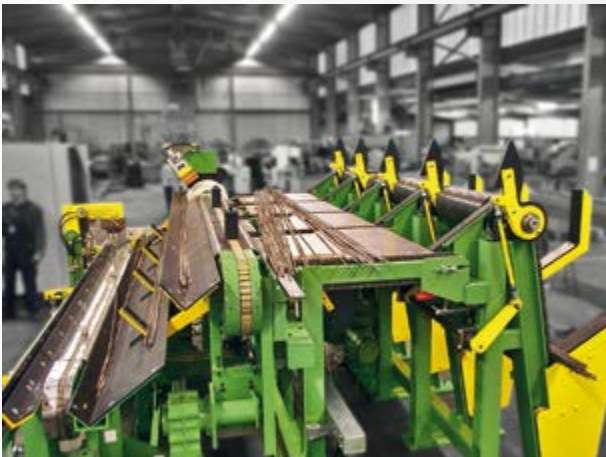
Stangenvereinzelung ab 4 mm Stangendurchmesser für geglühte Stahlstangen Separation system for minimum bar diameter of 4 mm, for annealed steel bars
