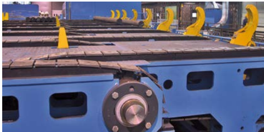
Stangenvereinzlung vor einer Schälmaschine bis Stangendurchmesser 320 mm Bar separation system in front of a peeling machine up to a bar diameter of 320 mm
