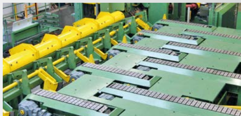
Einlauf und Auslauf für 2-Walzen-Richtmaschine Entry and exit system for a 2-roll straightening machine
