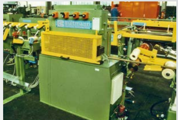
7-Rollen-Profilrichtmaschine für Messingstangen und -profile 7-roll profile straightening machine for brass bars and profiles
