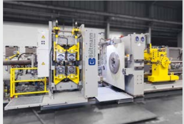
Schälmaschine für hochfeste Stahlstangen bis Ø 160 mm Peeling machine for high-strength steel bars up to Ø 160 mm
