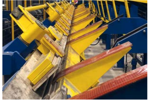
Fokus-Einlaufbahn für rundes Messingmaterial Focus-type entry roller table for round brass material
