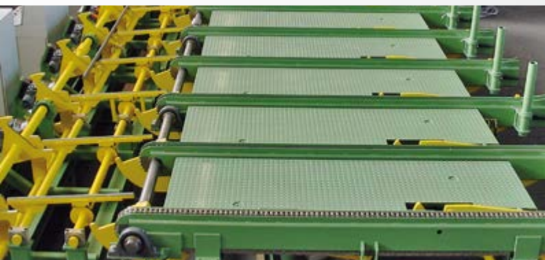
Einlauf und Auslauf einer Schälmaschine Entry and exit side handling systems of a peeling machine
