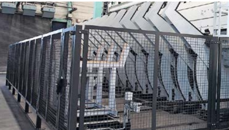
Bundbeladeseite einer Stangenvereinzlung Bundle loading within a bar separation system
