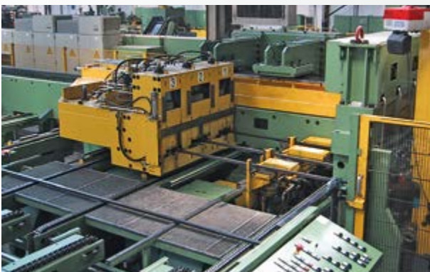
3-fach-Stangenziehanlage für Stahlstangen mit Einschubvorrichtung Triple drawing line for steel bars with push-in device
