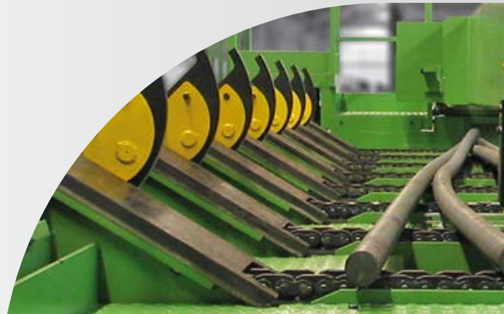
Stangenvereinzelung für schwarze Rundstangen Separation system for round black bars
