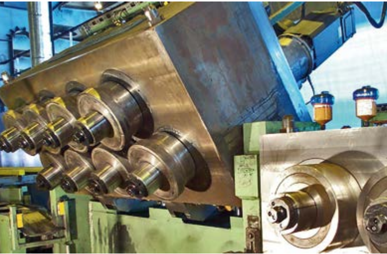
2 x 8-Rollen-Richtmaschine für Stahlstangen und Flachmaterial 2 x 8-roll straightening machine for steel bars and flats
