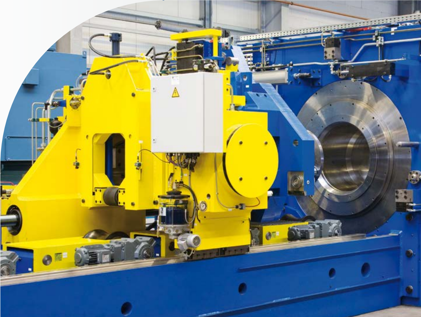
Auszugswagen einer Schälmaschine für Edelstahlstangen Extraction carriage of a peeling machine for special steel bars
