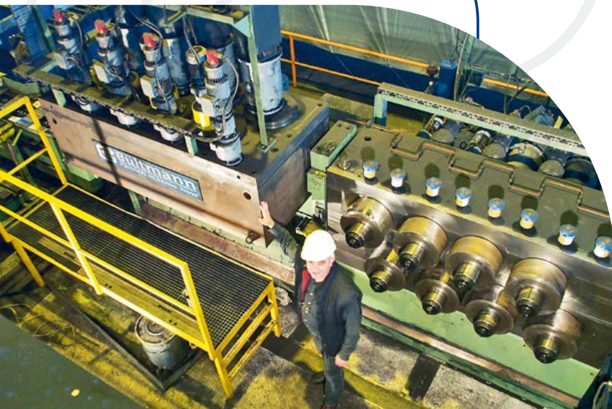
2 x 8-Rollen-Richtmaschine für Stahlstangen und Flachmaterial 2 x 8-roll straightening machine for steel bars and flats
