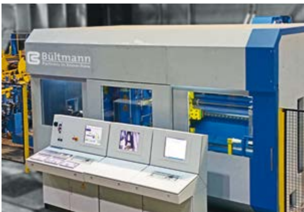
Schälmaschine für Edelstahlstangen bis zu 80 mm Stangendurchmesser
