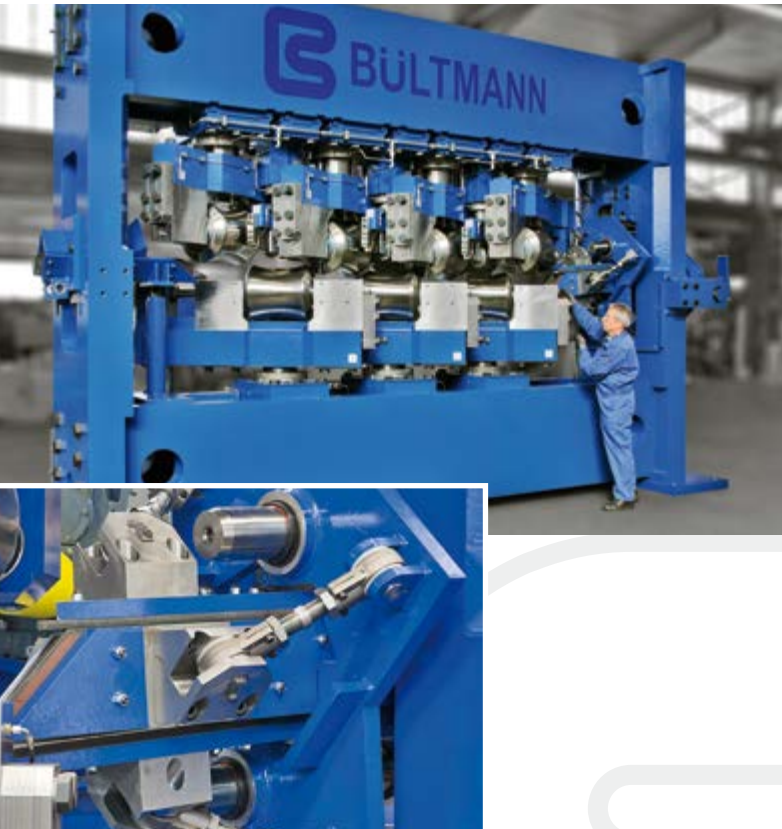
Einstellbare Einlaufführung Adjustable entry guiding
