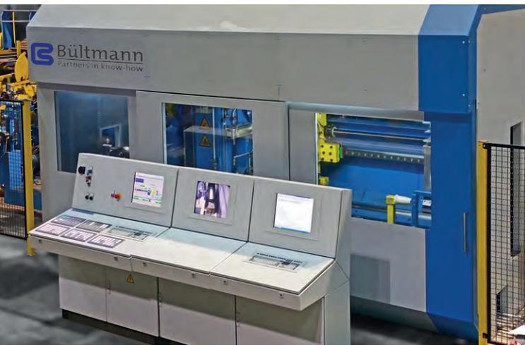
Das Schälen von Stabmaterial als Ausgangsprodukt für hochwertigen Blankstahl ist bei einem der größten deutschen Edelstahlhersteller nach wie vor ein entscheidender Produktionsschritt zum Erreichen einer hohen Produktqualität.
