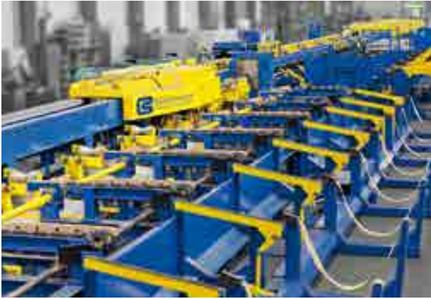
1-fach-Rohrziehanlage für Präzisionsstahlrohre, mit Dornstangenwechsellvorrichtung Single tube drawing line for precision steel tubes, with changing device for mandrel rods
