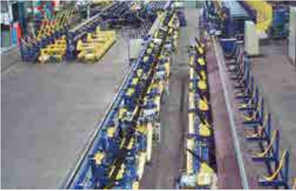
Rohrproduktionslinie für Edelstahlrohre mit automatischer Rohrvereinzlung, Prüflinie, Sägeanlage, Kunststoffstopfen-Verschlussanlage sowie Rohrablagensystem Tube production line for special steel tubes with automatic tube separation, testing unit, sawing equipment, capping device and tube discharge system
