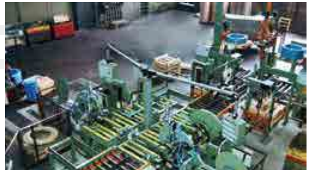
Abbinde- und Folienummantelung für Kupfercoils Unit for strapping and wrapping of copper coils
