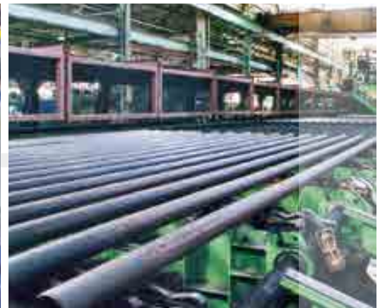
Pressenauslauf für kupferlegierte Rohre Runout system for copper-alloyed tubes
