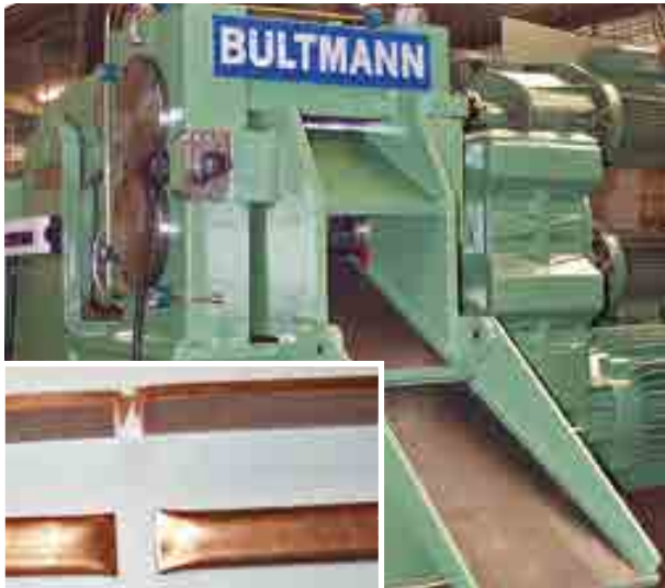
Schrotthacker für kupferlegierte Rohre und Stangen Scrap chopper for copper-alloyed tubes and bars
