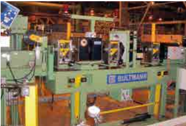
Prüftisch mit Wirbelstromprüfung für Stahlrohre Testing table with Eddy current testing for steel tubes
