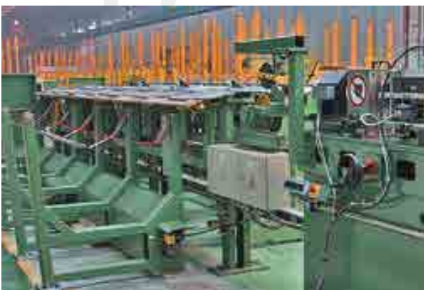
Prüfanlage mit Wirbelstromprüfung nach einer visuellen Prüfung für Stahlrohre Testing line with Eddy current testing, arranged behind visual testing of steel tubes
