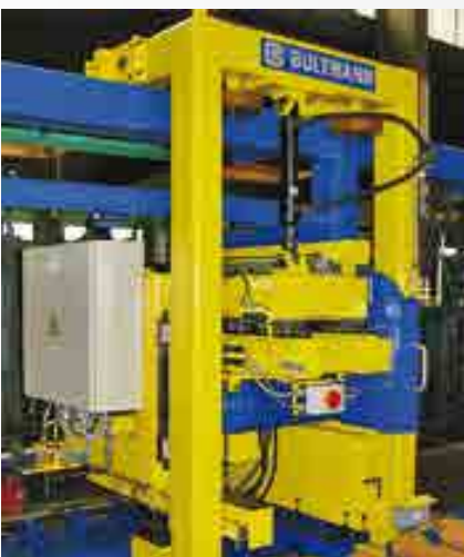
Lagensäge in Linie mit Zieh- und Richtanlage für Messingrohre und -profile Layer saw for brass tubes and profiles, working in line with drawing and straightening equipment
