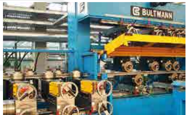
Richtmaschine für Quadrat- und Rechteckrohre mit einstellbaren Richtrollenabständen Straightening machine for quadratic and square tubes with adjustable straightening roll distances
