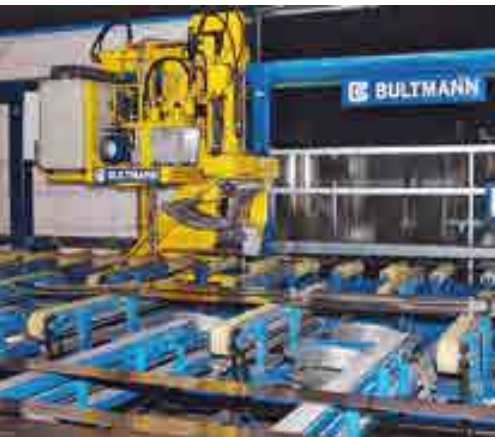
Puller im Auslauf einer Strangpresse für Aluminiumrohre und -profile Puller within the runout of an extrusion press for aluminium tubes and profiles
