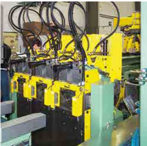
1-fach-Spanlostrennanlage für hochwertige Edelmetallrohre Single chipless cutting unit for high-grade precious metal tubes
