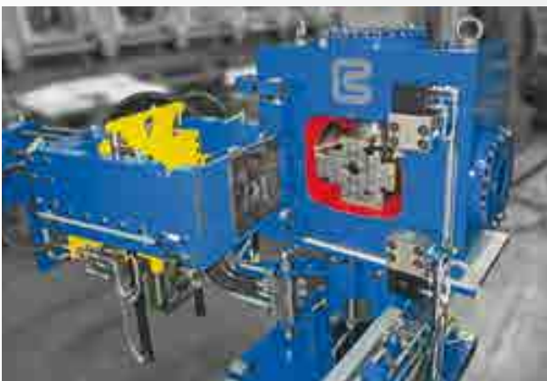
Faltangelmaschine HAM, kombiniert mit Push-Pointer Add-on für Stahlrohre Folding tag pointer HAM, combined with a push-pointer add-on for steel tubes
