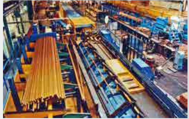
Rohrproduktionslinie für Kupferrohre mit automatischer Rohrvereinzlung, Anspitzanlage, 3-fach-Rohrziehmaschine sowie Sägelinie Tube production line for copper tubes with automatic tube separation, pointing machine, triple drawing machine and sawing equipment
