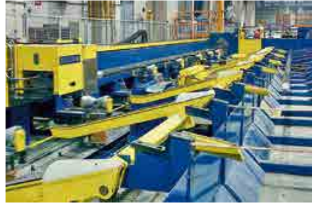
Rohrziehanlage für Präzisionsstahlrohre, mit Sägeanlage Production line for precision steel tubes, with sawing unit
