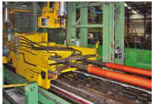
2-fach-Innenspannsystem für Kupferrohre Double internal gripper system for copper tubes
