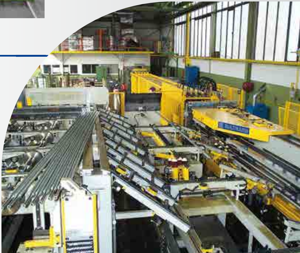
Produktionslinie für Aluminiumrohre mit automatischer Rohrvereinzlung, mit einer ersten 2 x 2-fach-Rohrziehmaschine, einer zweiten 2 x 2-fach-Rohrziehmaschine, hydraulischer Schere sowie Prüf- und Sägeanlage Production line for aluminium tubes with automatic tube separation, with two drawing machines for aluminium tubes, each one designed for 2 x 2 drawing passes, hydraulic shears, testing and sawing units
