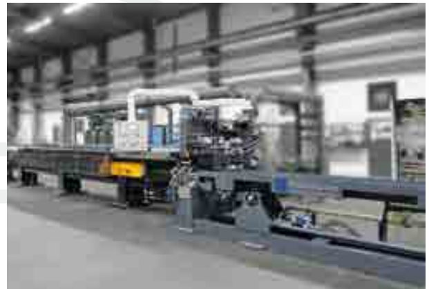
2-fach-Rohrziehanlage für Edelstahlrohre, mit Kettenantrieb Double tube drawing line for stainless steel tubes, driven by drawing chain
