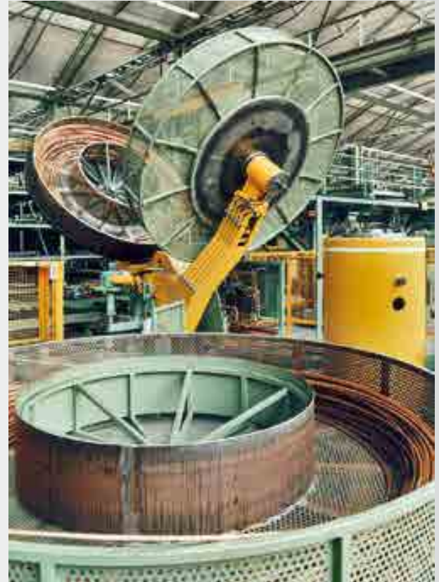
Coilwendeeinrichtung für Kupfercoils Coil turning station for copper coils
