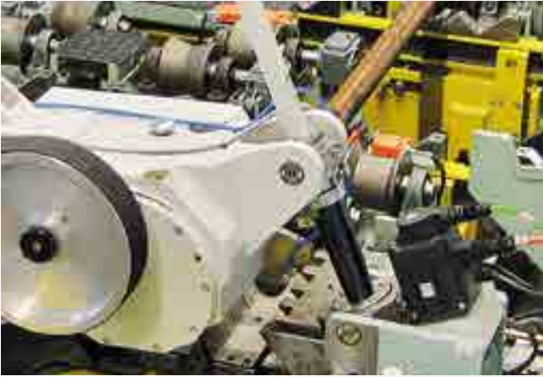
Sägeanlage mit Fasanlage für hochlegierte Stahlrohre Sawing line with chamfering unit for high-alloyed steel tubes
