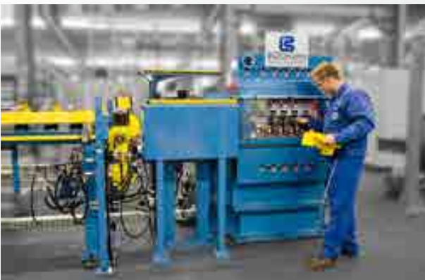
10-Rollen-Rohrrichtmaschine für Edelstahlrohre 10-roll straightening machine for special steel tubes
