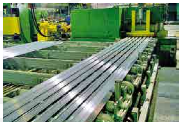
Lagensäge im Auslauf einer Strangpresse, für Aluminiumrohre und -profile Layer saw for aluminium tubes and profiles, arranged in the runout of an extrusion press
