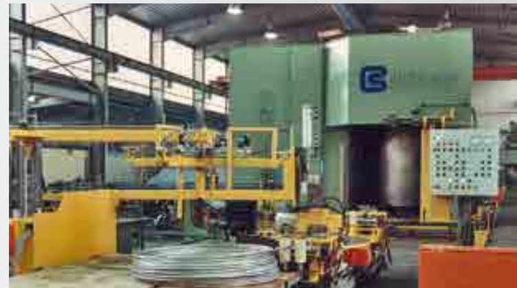
Trommelziehmaschine mit vertikaler Ziehtrommel, Push-Pointer und Zuführsystem der Ziehangel zur Matrize, für Stahlrohre Bull block with vertical drum for steel tubes, push-pointer and device for feeding the point into the die
