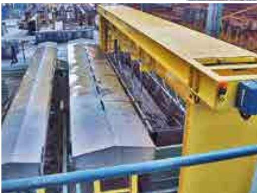
Automatische Rohrbundbefettungs- anlage für Stahlrohre Automatic bundle greasing line for steel tubes
