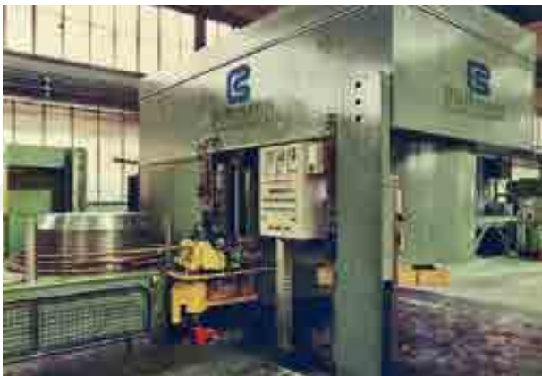
Trommelziehmaschine mit hängender Ziehtrommel für Kupferrohre und kupferlegierte Rohre Bull block with hanging drum for copper and copper-alloyed tubes
