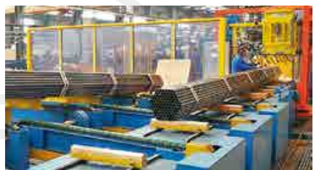
Bundtransport und Abtropfstation für Stahlrohre Bundle transport and draining station for steel tubes
