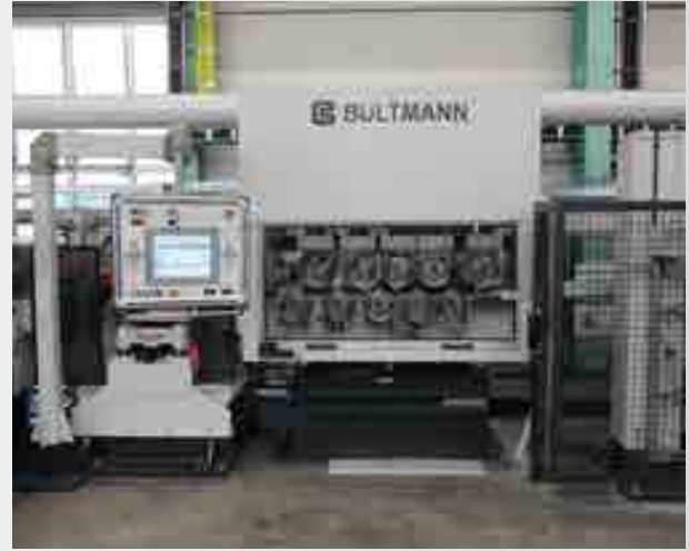
10-Rollen-Richtmaschine für Kupferrohre und -stangen 10-roll straightening machine for copper tubes and bars
