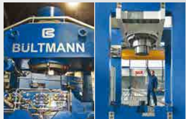
2-Rollen-Richtmaschine für nahtlose Stahlrohre und Stangen 2-roll straightening machine for seamless steel tubes and bars
