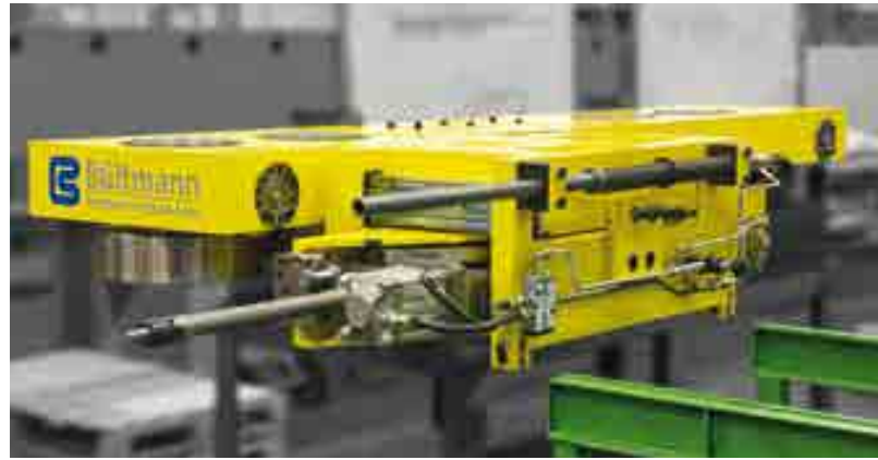
Ziehwagen mit 1-fach-Rohrinnenspannzange für Kupferrohre Drawing carriage with single internal gripper for copper tubes
