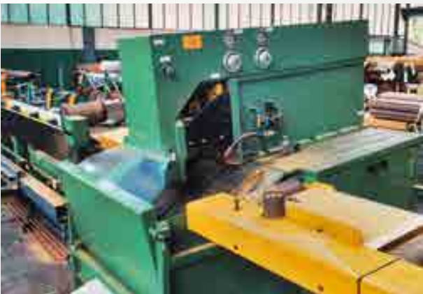
Lagensäge in Linie mit Zieh- und Richtanlage für Messingrohre und -profile Layer saw for brass tubes and profiles, working in line with drawing and straightening equipment
