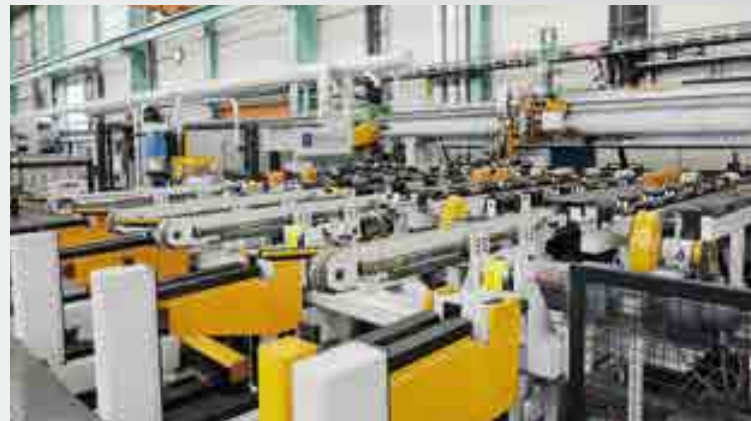
Sägeanlage mit Spezial-Vorschubsystem für Kupferrohre und -stangen Sawing unit with special feed system for copper tubes and bars
