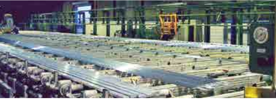
Pressenauslauf für Aluminiumrohre und -profile Runout system for aluminium tubes and profiles
