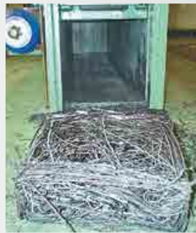
Ausgabeschacht einer Spänepresse mit Spanpaket Discharge chute of swarf press, with swarf pressed in to a package
