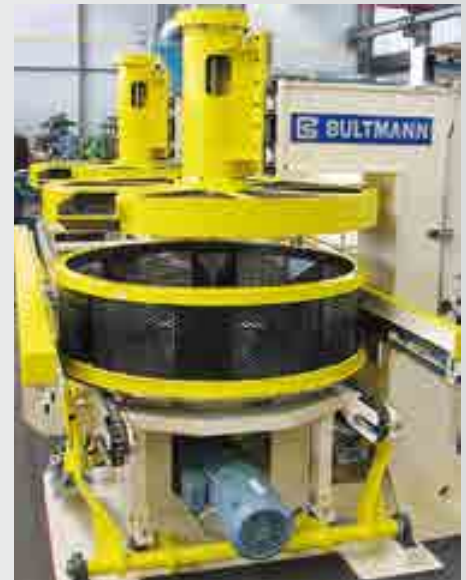
Aufcoiler im Pressenauslauf für kupferlegierte Rohre und Profile Coiler for copper-alloyed tubes and profiles, arranged in the runout of an extrusion press
