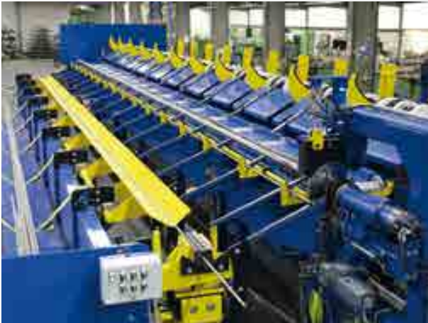
Automatische Rohrvereinzelung vor einer Anspitzmaschine für Stahlrohre Automatic tube separation, installed upstream of a pointing machine for steel tubes
