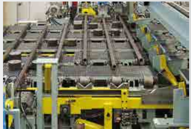
Fasanlage für Stahlrohre mit vorgelagerter Hochleistungskaltkreissäge Chamfering unit for steel tubes, installed behind a high-speed cold circular saw
