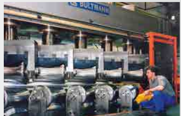
10-Rollen-Richtmaschine für Aluminiumgroßrohre 10-roll straightening machine for large-diameter aluminium tubes
