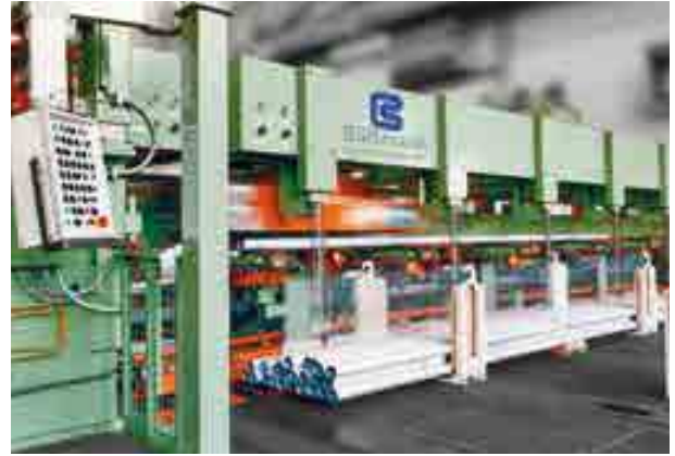
2-fach-Rohrziehanlage für Aluminiumrohre, mit Vakuumhandling Double tube drawing line for aluminium tubes, with vacuum handling
