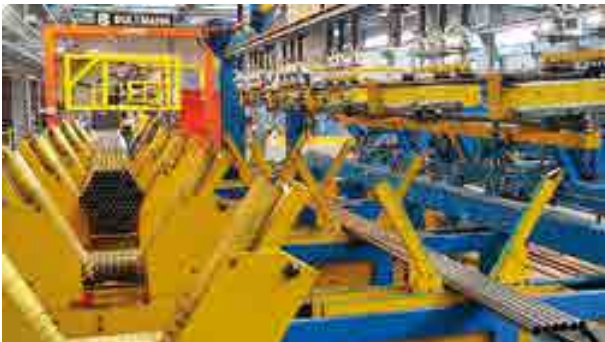
Bündel- und Abbindeanlage für Stahlrohre Bundling and strapping unit for steel tubes
