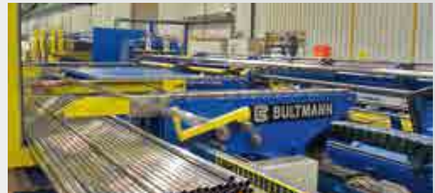
Späneausblasanlage für Stahlrohre, mit Fasanlage Swarf blow-off unit for steel tubes, with chamfering machine
