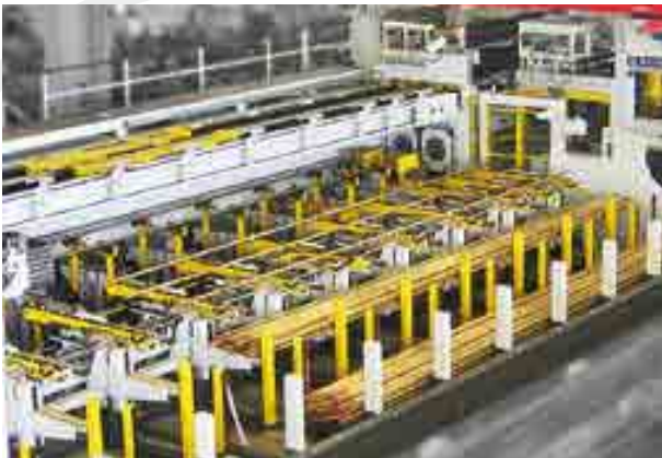
2-fach-Rohrziehanlage für Kupferrohre und kupferlegierte Rohre, mit Zahnstangenantrieb, mit automatischer Rohrvereinzlung Double tube drawing line for copper and copper-alloyed tubes, driven by toothed rack, with automatic tube separation
