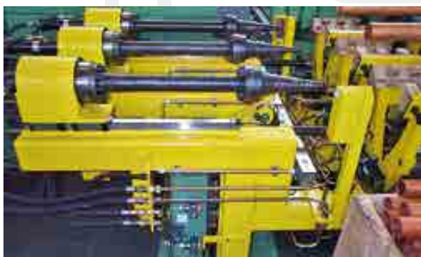
Rohraufweineinrichtung für spanlos getrennte Kupferrohre Tube expanding device for swarfless cut copper tubes
