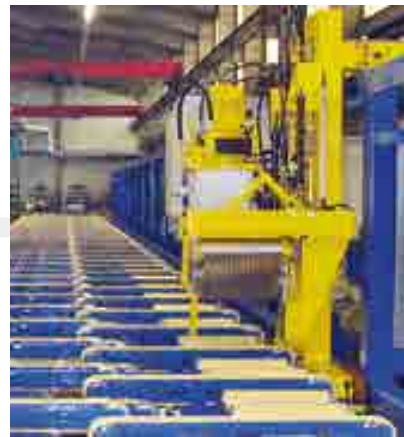
Puller im Auslauf einer Strangpresse für Aluminiumrohre und -profile Puller within the runout of an extrusion press for aluminium tubes and profiles
