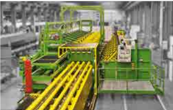
Produktionslinie für Präzisionsstahlrohre mit Anspitzanlage, 4-fach-Rohrziehmaschine und Spanlostrennanlage Production line for precision steel tubes with pointing machine, quadruple tube drawing machine and swarfless cutting unit
