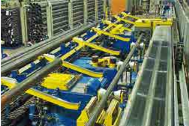
1-fach-Rohrziehanlage für Stahlrohre, mit Zahnstangenantrieb und Sägeanlage Single tube drawing line for steel tubes, driven by toothed rack, with sawing unit
