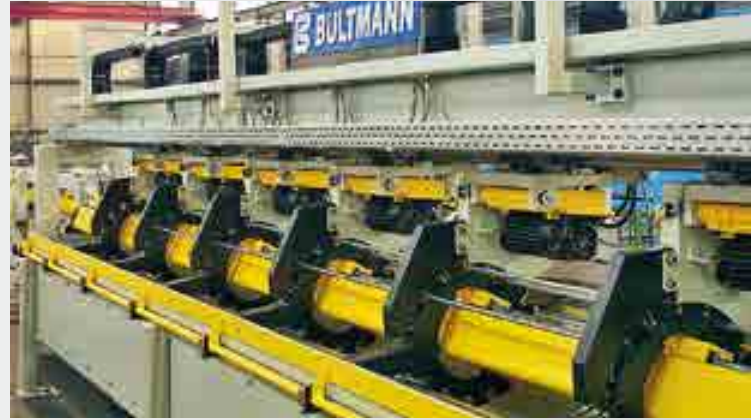
Fixlängensäge für Aluminiumrohre Fixed length saw for aluminium tubes
