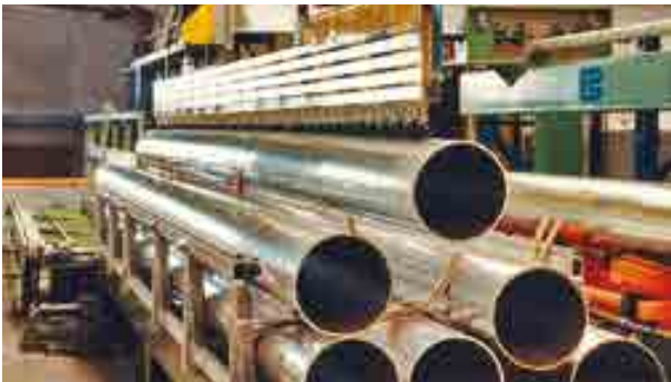
Vakuumtransportsystem für Aluminiumrohre Vacuum transport system for aluminium tubes
