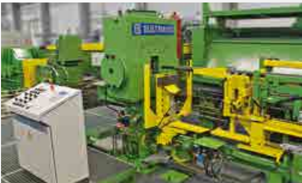
Faltangelmaschine HAM 150 für Stahlrohre, mit Zangen- vorschub zur stufenlosen Erzeugung unterschiedlicher Ziehangelängen Folding tag pointer HAM 150 for steel tubes, with grip- per feed to ensure a continuous production of different point lengths
