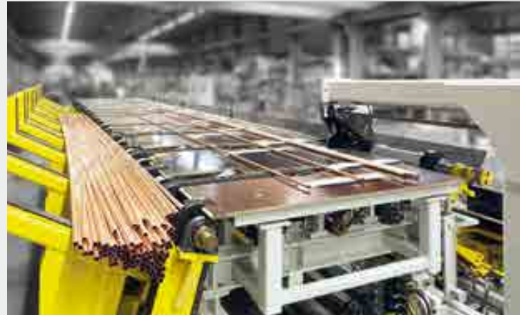
Rohrvereinzelung vor einer Richt- und Sägelinie für Kupferrohre Tube separation, installed upstream of a straightening and sawing line for copper tubes
