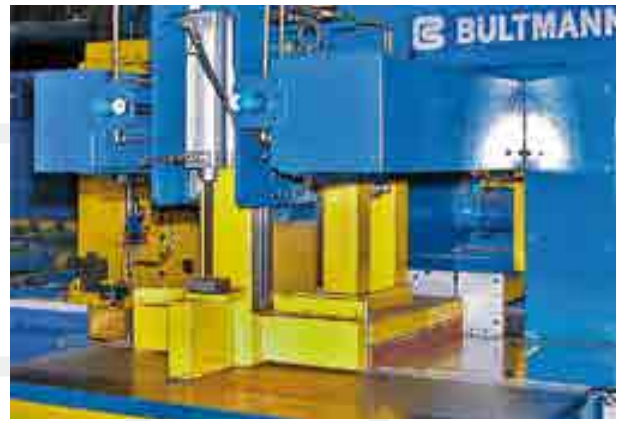
Lagensäge im Auslauf einer Presse für Aluminiumrohre Layer saw for aluminium tubes, arranged in the runout of an extrusion press
