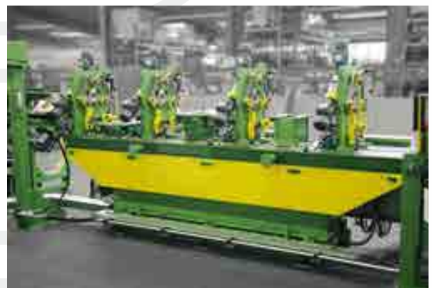
Prüftisch mit Präzisions-Triple-Treibereinheiten und Schiebetischen für Prüfelektronik Testing table with precision triple pinch roll units and with sliding tables for testing electronics
