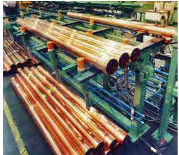
Cu-Rohrschweißanlage für Regenfallrohre Copper tube welding line for downpipes
