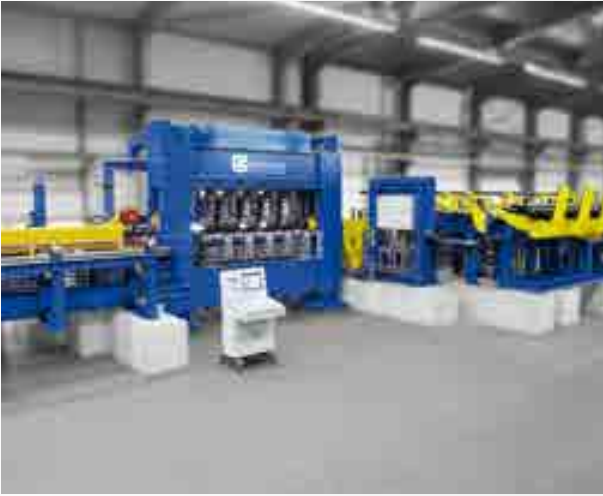
10-Rollen-Richtmaschine für Präzisionsstahlrohre 10-roll straightening machine for precision steel tubes
