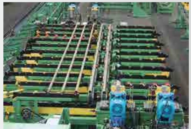
Doppelfasanlage für Stahlrohre, in Linie mit Zieh-, Richt-, Säge- und Prüfanlage Double chamfering unit for steel tubes, working in line with drawing, straightening, sawing and testing equipment
