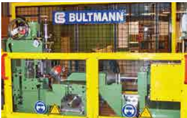
Schrotthacker für Kunststoffummantelung und Kupferrohre Scrap chopper for plastic coating and copper tubes
