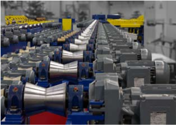
Mehr als tausend angetriebene Prismenrollen übernehmen den Rohrtransport in Längsrichtung.
