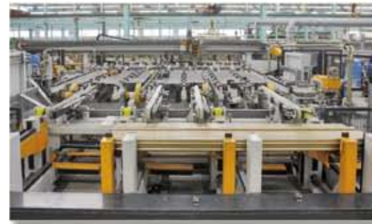
Sägeanlage - Fasanlage Sawing unit - Chamfering unit
