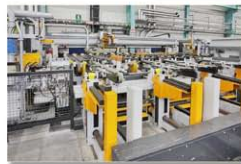
Sägeanlage - Fasanlage Sawing unit - Chamfering unit
