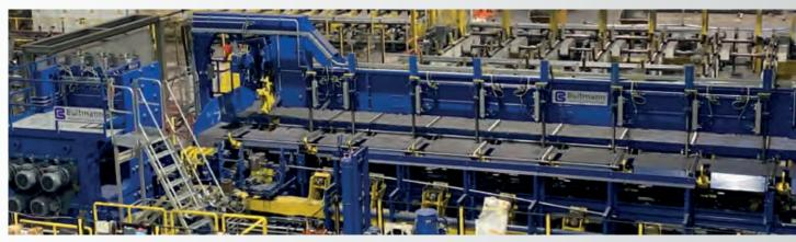
Einer der größten internationalen Stahlproduzenten brachte sein Vertrauen in Bültmann Stahlstangenproduktionsanlagen durch die Bestellung einer 5-Walzen-Vorrichtmaschine für hochfeste Stahlstangen mit Ø 20 - 100 mm und Längen von 4 - 12 m für seinen Betriebsstandort Frankreich zum Ausdruck.
