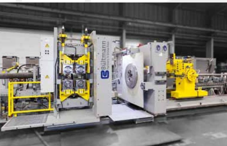
Schälmaschine, Typ SH 060, für Fertigdurchmesser 10 - 60 mm und Stangenlängen 2,5 - 6,5 m.
